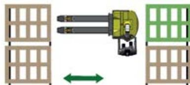
Die seitliche Position des Bediener vermeidet das Zerquetsch- oder Einklemmrisiko und erlaubt den Einsatz des Combi-PPT in sehr schmalen Gängen.
